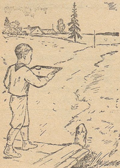
Рис. 13. Зонкаок ориентируйтö планшет да пятнайтö булавакөн точка, кöдасянь пондöтö снимайтны.
