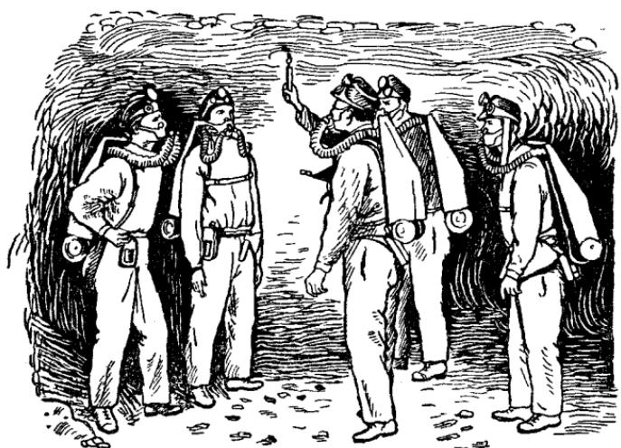
52 ris. Kislorodən tırtəm cilindraezən spasaşənəj otrjad. Cilindraes krepitəm tıskaezən. Kislorodys cilindraeziş pırə rezinə mesəkə puktəm predoxranitelənəj korovkaə, a sişan çuzəm vylə kbsaləm trubka kuşa maskazınköf dənə.
