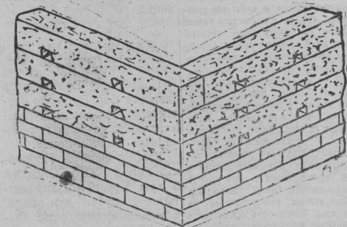
Вид части глинобитной стены на фундаменте.
