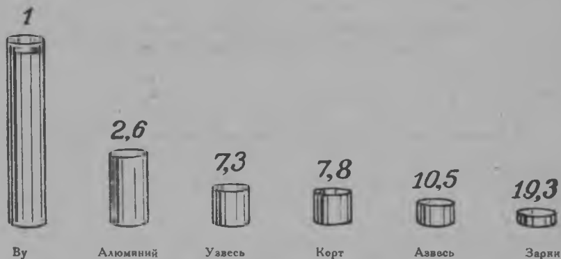
36. сур. Одыг кадь секталао пӧртэм металл'эслэсь лэсьтэм цилиндр'эс.
