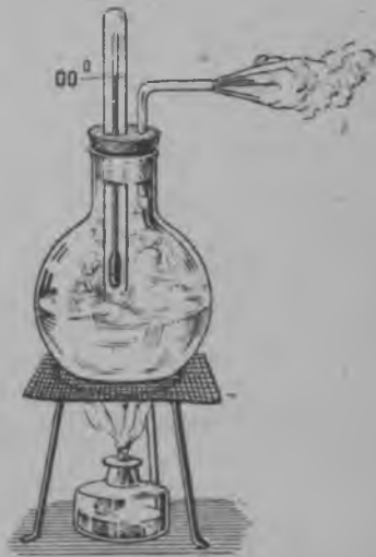
55 сур. Термометр пёзись ву пар пушкын.
