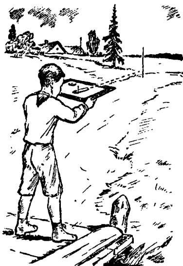
14 суред. Пичипи визирной линейкаез майыг вадьсы тупатыз.
